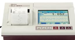
**Testeur d'état de surface portable SJ-310**
